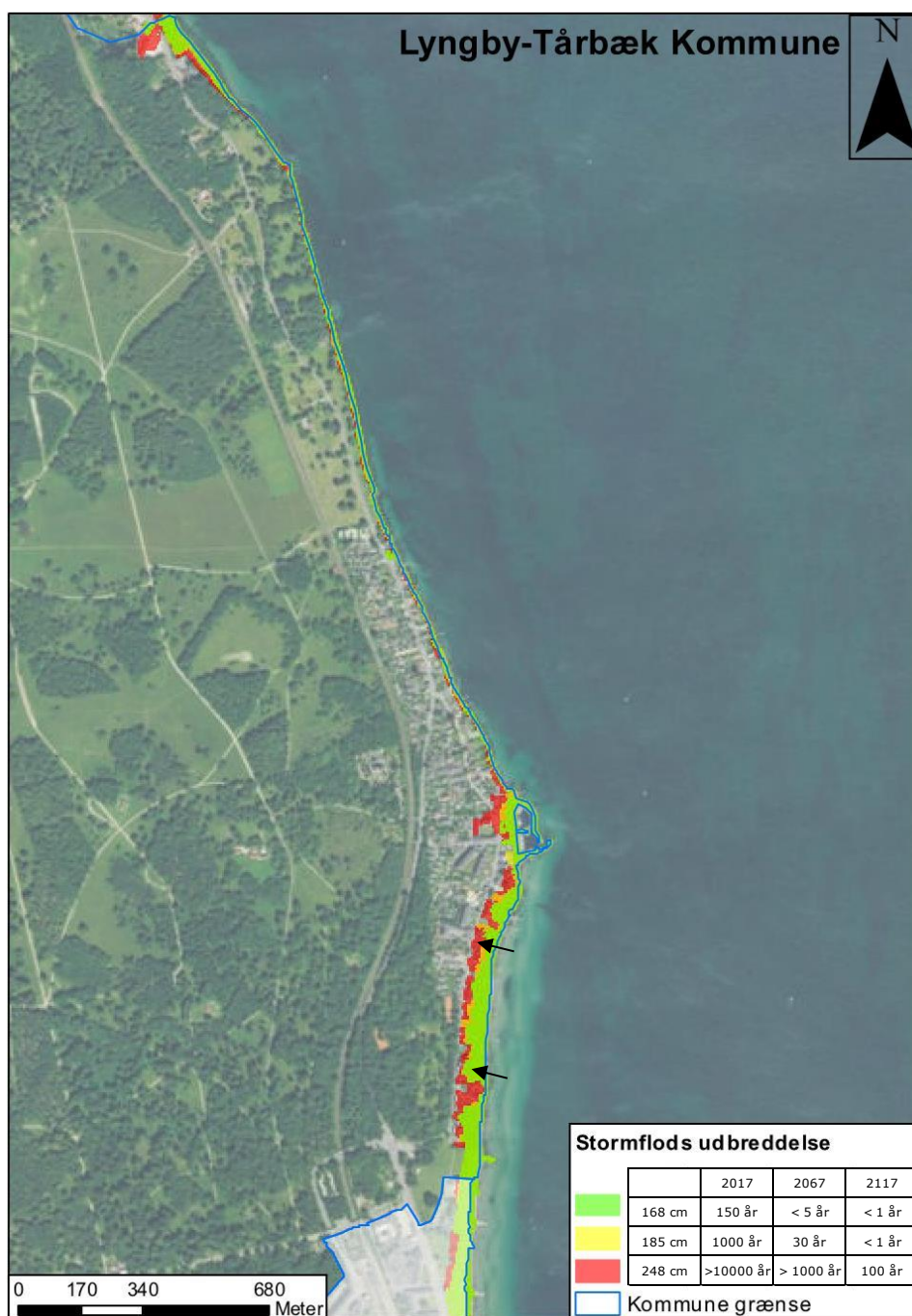
Figur 6-1 Kort over oversvømmede arealer ved stormflod fra nord i Lyngby-Taarbæk Kommune. Koterne på kortet referer til referencevandstanden ved Nordre Toldbod. Med sorte pile er angivet de primære veje, vandet kommer ind. Vandet breder sig direkte ind over land fra havsiden og der er ingen særlige strømninger bagom diger eller forhøjninger.
