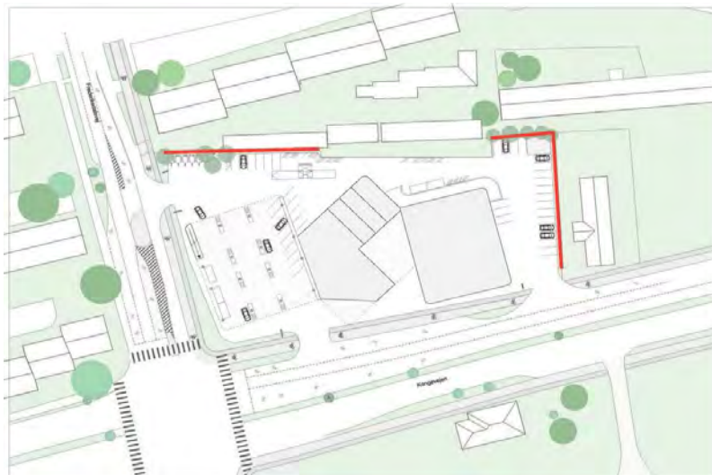
Figur 6. Situationsplan med støjvæg i skel til naboejendomme mod vest og nord, Holscher Arkitekter.
