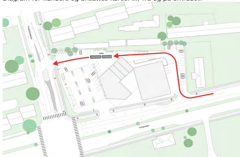
Tankvognes kørsel til og fra påfyldningszone på området.
