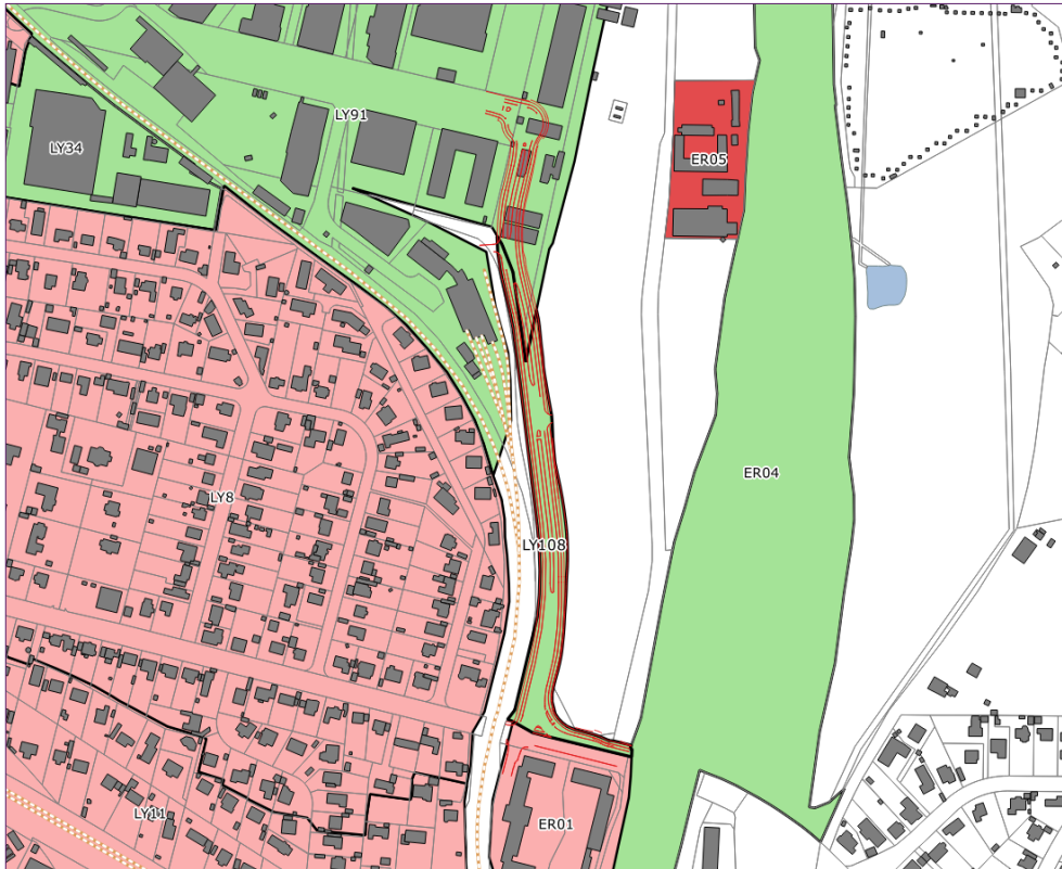
Figur 2 Ændret anvendelse af kloakopland LY91, reduktion af opland ER01 og nyt kloakopland LY108 vedr. forlængelsen af Firskovvej. Røde streger angiver det nye vejtracé.
