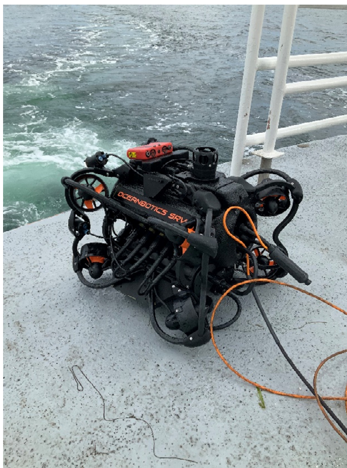
Figur 2.1. RSV-8 ROV under arbejde på Taarbæk Rev
