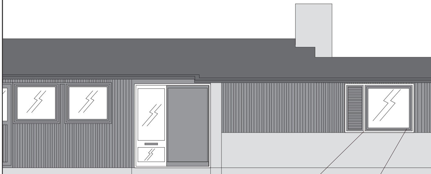
Udsnit af facade med nye vinduer i de oprindelige karme
