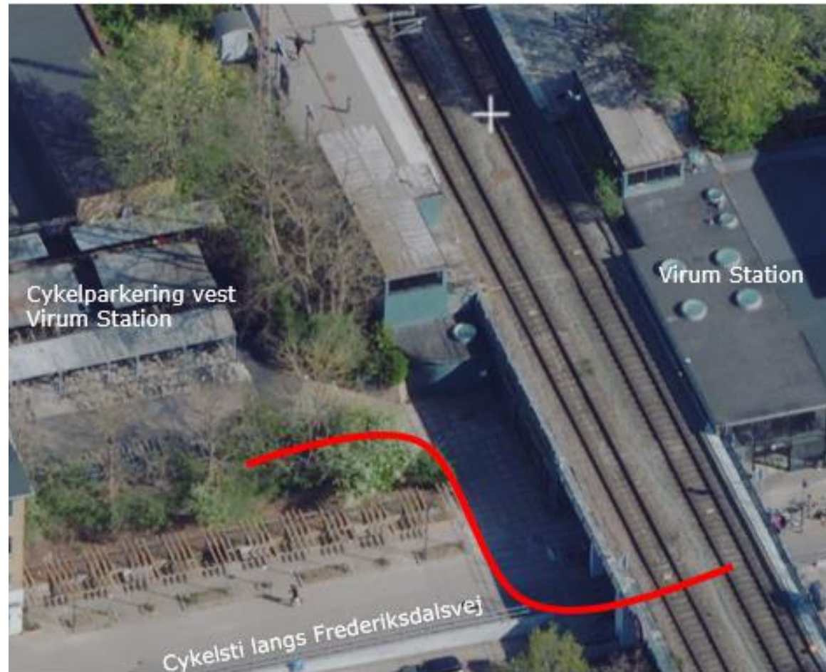
73 Der bør sikres cyklende forbindelse direkte til cykelparkering for at sikre at den bliver brugt (skitseret med rød). Derudover skal belægning, cykelstativer og overdækning udskiftes og der skal etableres attraktiv belysning.
