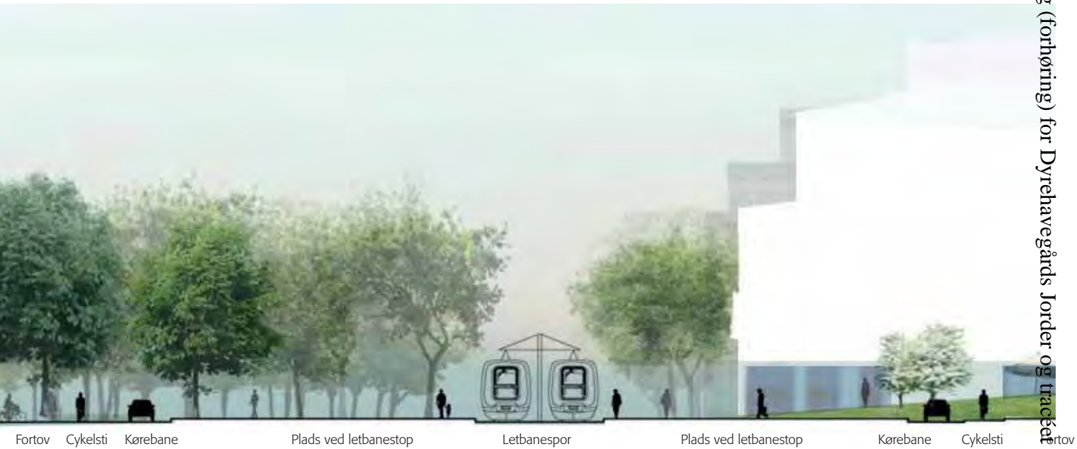
LETBANE I VEJPROFILET Letbanesporer placeres i som midterprofil på Lundtoftegårdsvej
