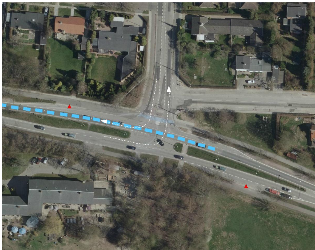
Figur 9: Køddannelser på Klampenborgvej skaber problemer med at komme til og fra Hjortekærvej. De blå bokse illustrerer biler, der holder i kø. De hvide linje bilister illustrerer bilister, der kan have svært ved at komme ud og ind på Hjortekærvej. De røde trekanter viser eksisterende busstoppesteder.
