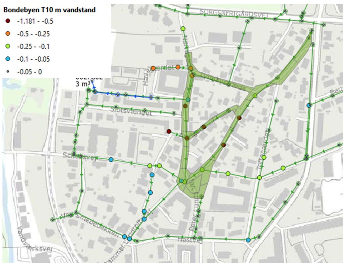
Figur 4: Beregnet reduktion i vandstand i fællesystemet for gentagelsesperioder på 10 år ved status og efter afskæring af vejvand. Med grønt er vist de arealer der afskæres og ledes i nyt system til bassin og videre til Mølleåen.
