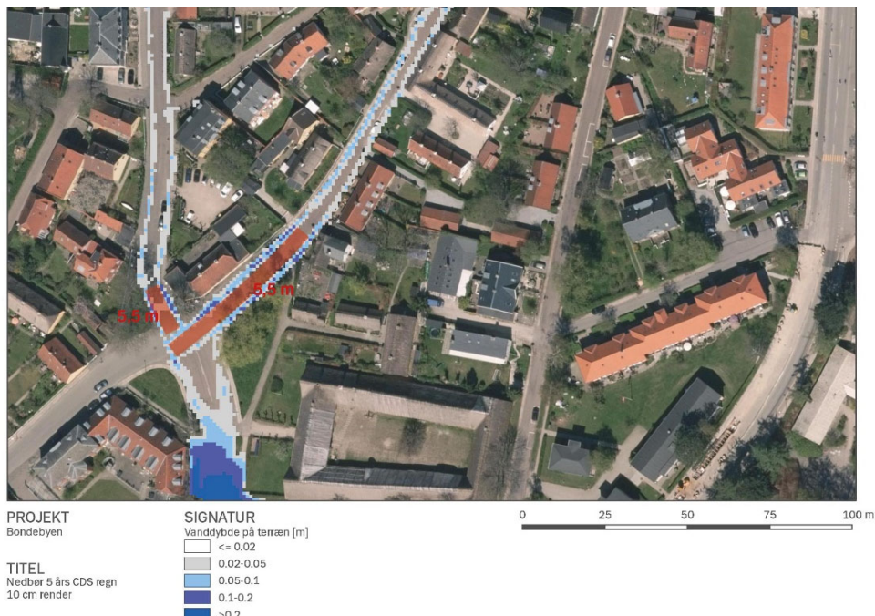
Figur 13: Krydset ved Gl. Lundtoftevej, Peter Lunds Vej, Nørregade. Maksimal vanddybde på terræn ved en 5-års hændelse. Render med en dybde på 10 cm. (Se fuld størrelse af illustration i bilag). Den røde markering angiver 5,5 m kørebane.
