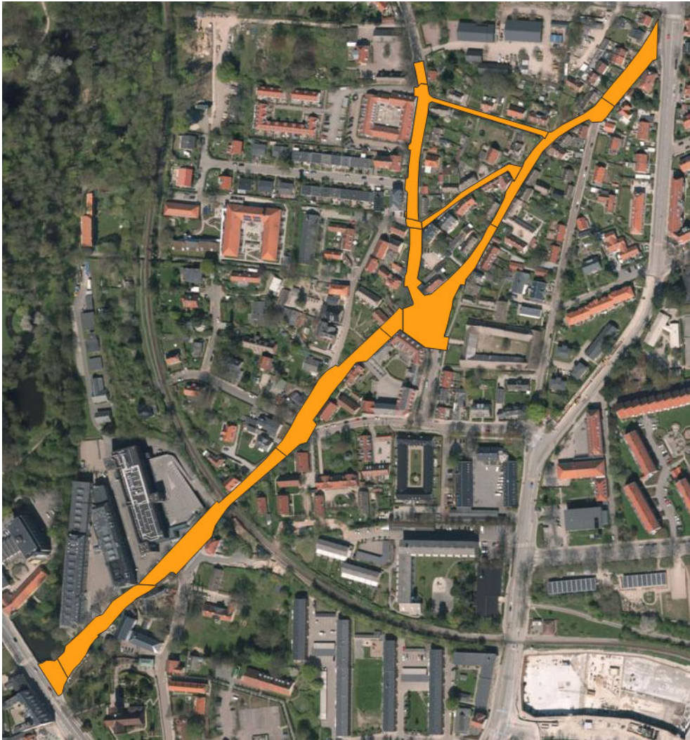
Figur 25: Vejstrækninger hvor der fastholdes et fint mesh til simulering af skybrud.
