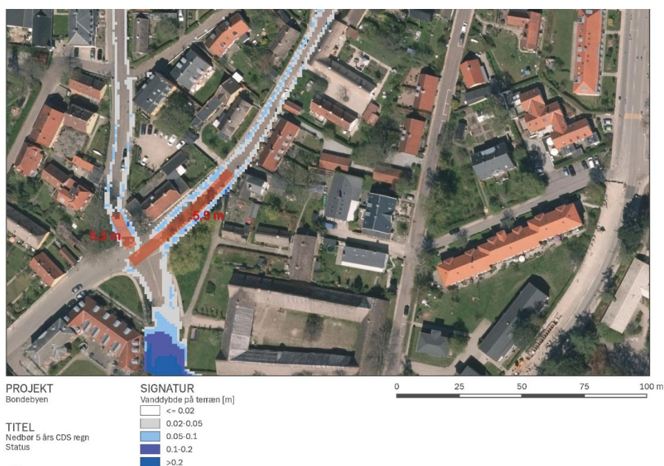
Figur 11 Krydset ved Gl. Lundtoftevej, Peter Lunds Vej, Nørregade. Statusmodel, hvor vejriste er afproppet. Maksimal oversvømmelse på terræn ved en 5-års hændelse. (Se fuld størrelse af illustration i bilag). Den røde markering angiver 5,5 m kørebane.
