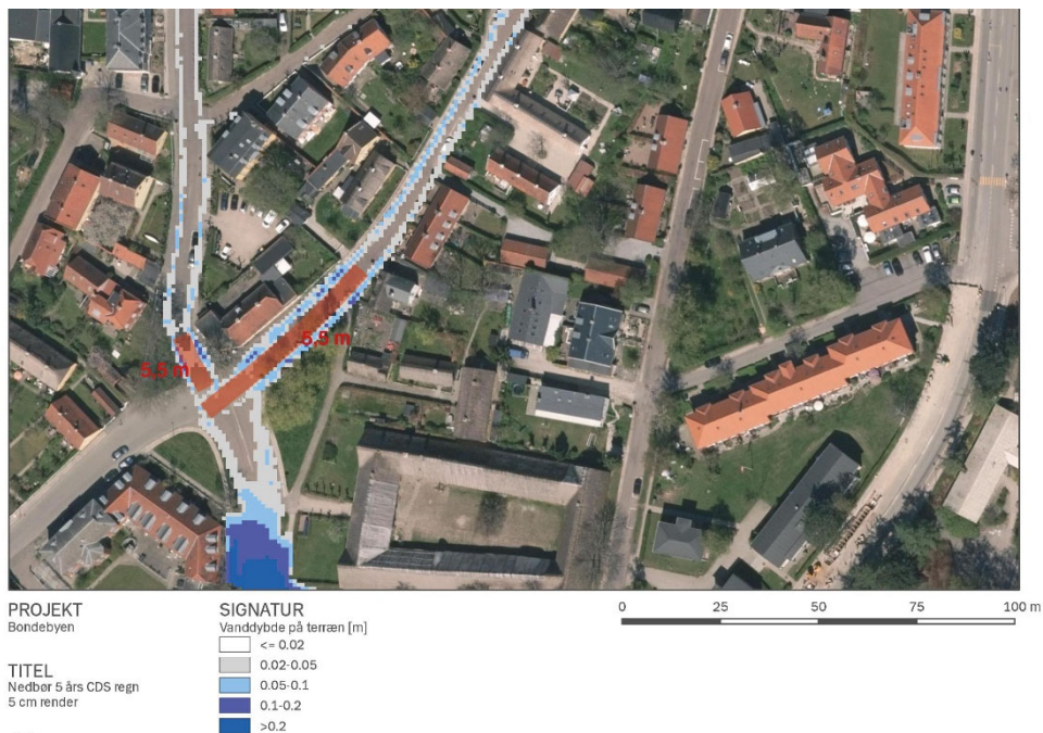
Figur 12: Krydset ved Gl. Lundtoftevej, Peter Lunds Vej, Nørregade. Maksimal vanddybde på terræn ved en 5-års hændelse. Render med en dybde på 5 cm. (Se fuld størrelse af illustration i bilag). Den røde markering angiver 5,5 m kørebane.
