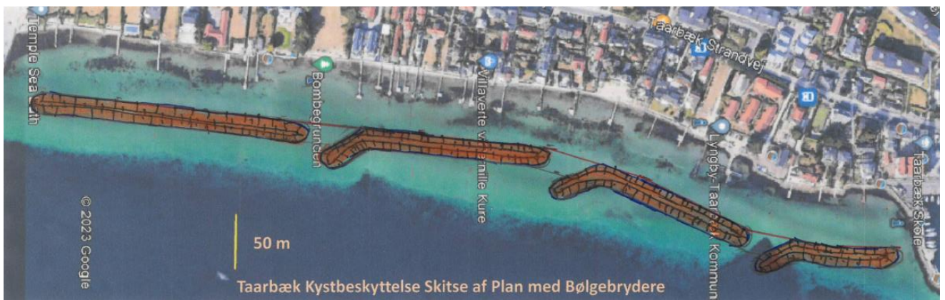
Figur 8 Konceptuel udformning af løsning med offshore bølgebrydere, placeret i en afstand på ca. 50 m fra kysten
