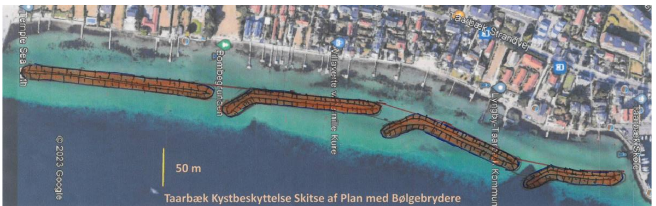
Figur 5 Konceptuel udformning af løsning med offshore bølgebrydere, placeret i en afstand på ca. 50 m fra kysten
