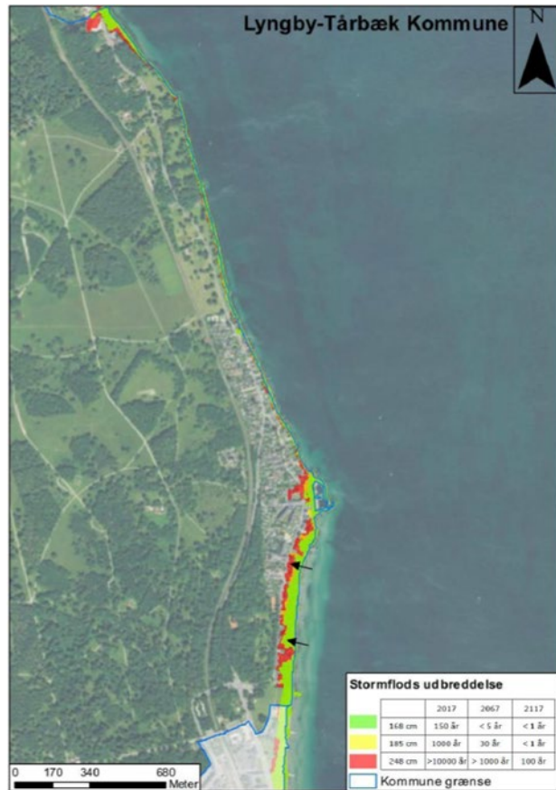
Figur 2: Kort over oversvømmede arealer ved stormflod fra nord i Lyngby-Taarbæk Kommune. Koterne på kortet referer til referencevandstanden ved Nordre Toldbod. Med sorte pile er angivet de primære veje, vandet kommer ind. Vandet breder sig direkte ind over land fra havsiden og der er ingen særlige strømninger bagom diger eller forhøjninger.
