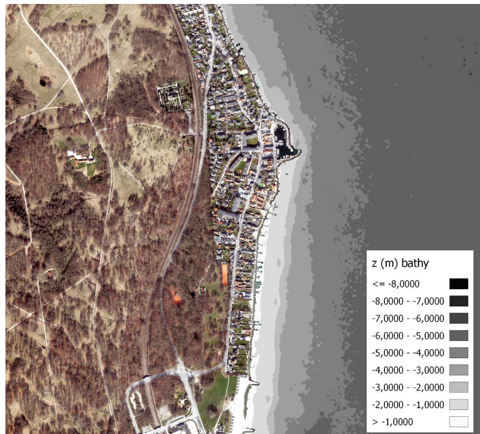
Figur 10 Kombinerede opmålte og satellitbaserede bundkoter.
