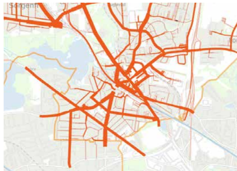
Diagram der viser korte ture i bil fra 0,5 til 5 kilometers længde. Tykke streger er lig med større mængde uagtet vejgeometri. Diagrammet viser med al tydelighed, at der er et stort potentiale i at ændre trafikvaner og flytte noget af trafikken fra bil til cykel eller gåben på de relativt korte ture i Lyngby Centrum.
