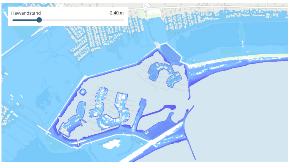
Figur 5-6 Oversvømmelse fra havet i Vallensbæk Havn ved vandstand i kote 2,4. Hele havneanlægget er oversvømmet ved kote 3,0 (SCALGOlive).
