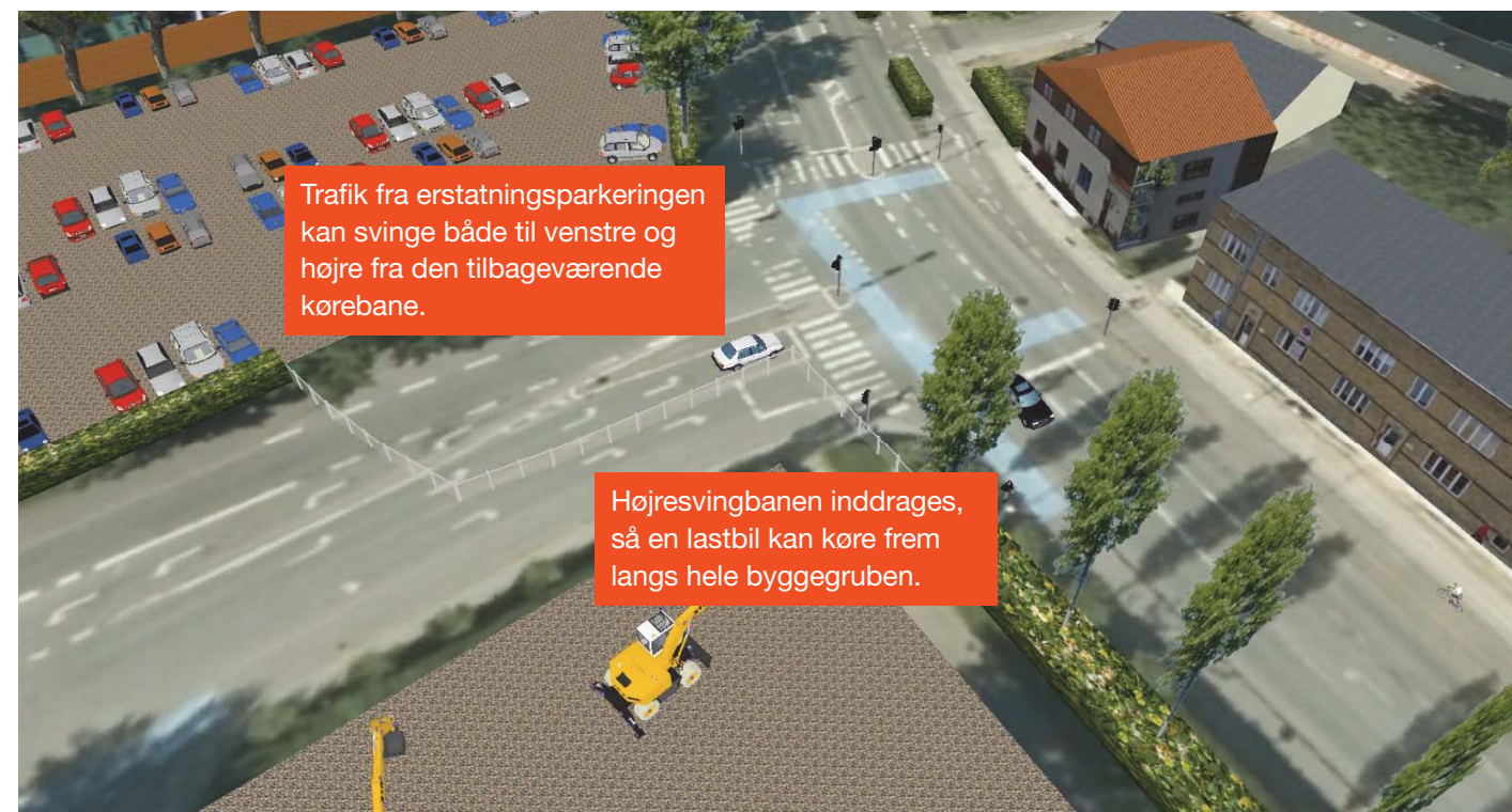
Der opretholdes adgang til og fra erstatningsparkeringen fra Toftebæksvej. Højresvingbanen på Kanalvej er inddraget for at give plads til byggeriet.
