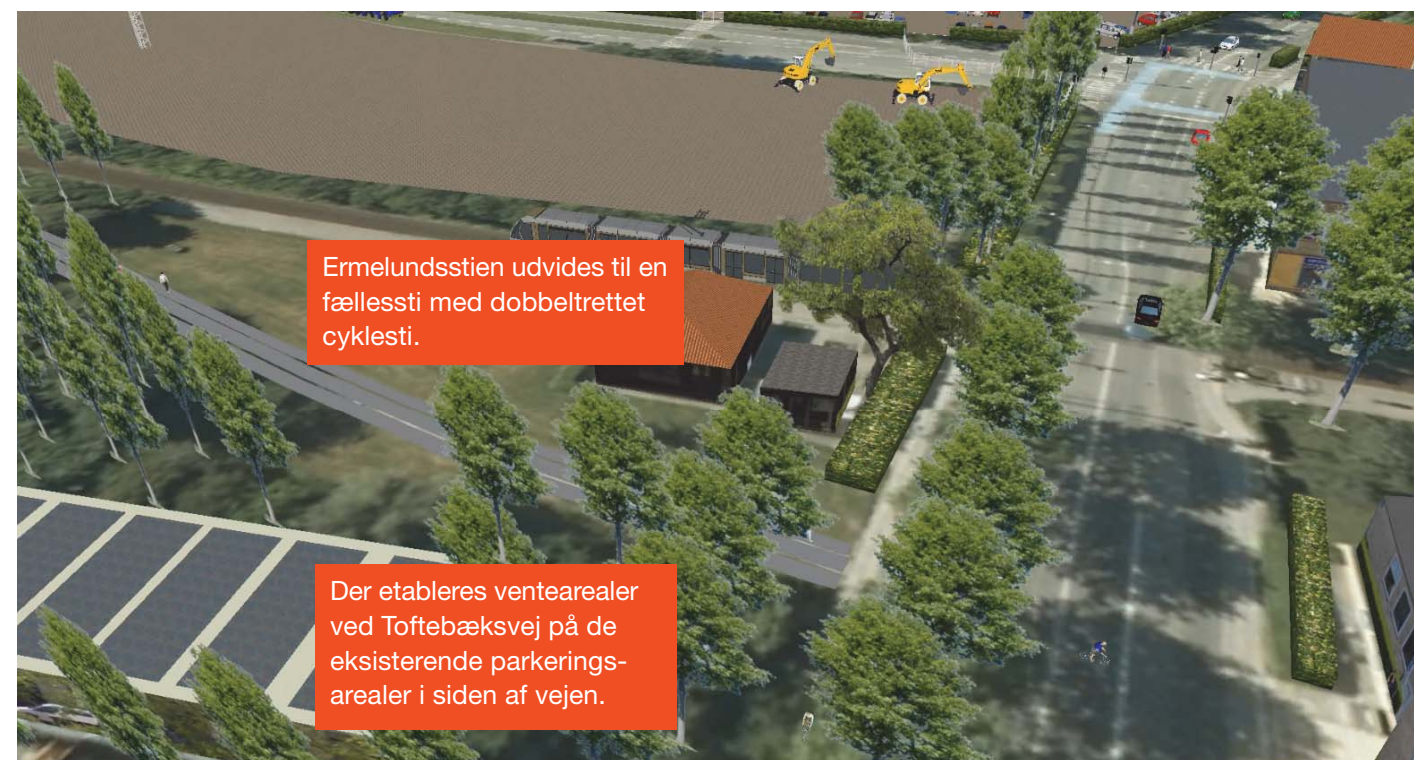
Ermelundsstien mellem Klampenborgvej og Toftebækvej udvides til min. 3,5 m, så der er plads til både cyklister og fodgængere. Der etableres belysning og ventearealer til cyklister, der skal krydse Toftebæksvej.
