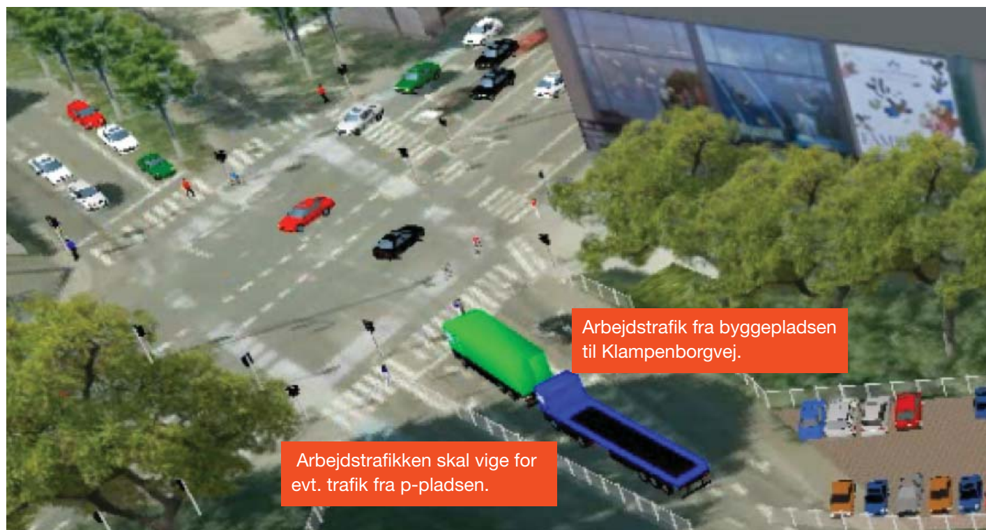
Arbejdstrafikken fra byggepladsen benytter venstresvingbanerne fra Kanalvej til Klampenborgvej.
