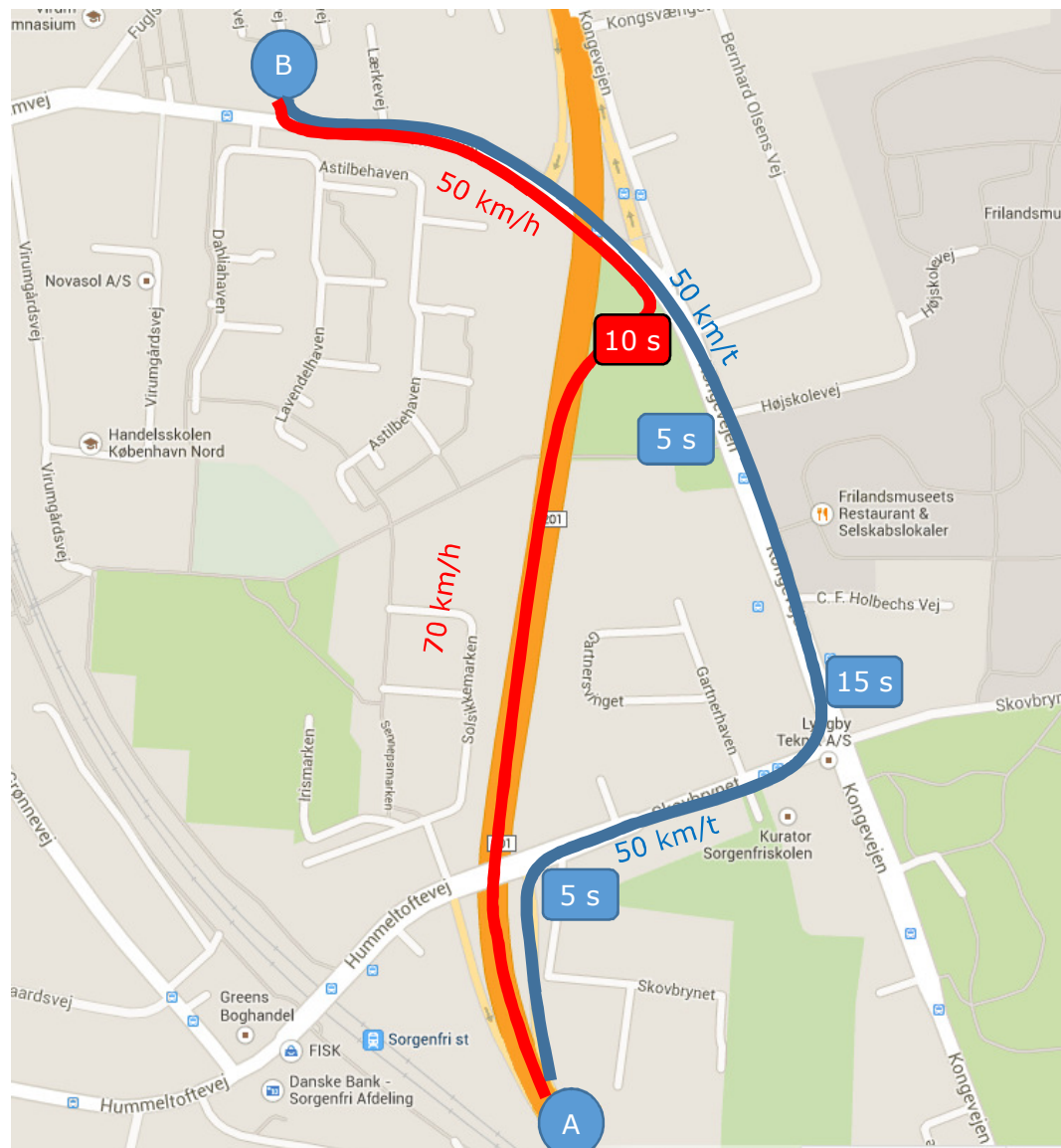
Figur 12: Eksempel på forbedret rejsetid ved ny rampe. Blå: eksisterende rute. Rød: ny rute. Bemærk at hastigheden på Lyngby Omfartsvej er forudsat nedsat til 70 km/h
