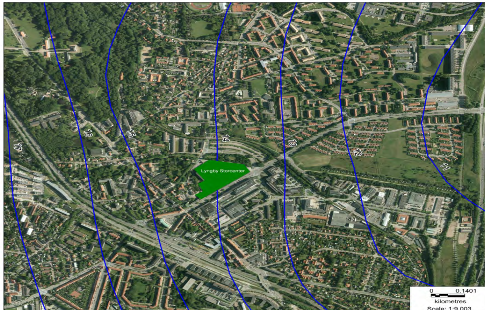
Figur 2-3 Grundvandspotentiale i det primære magasin.
