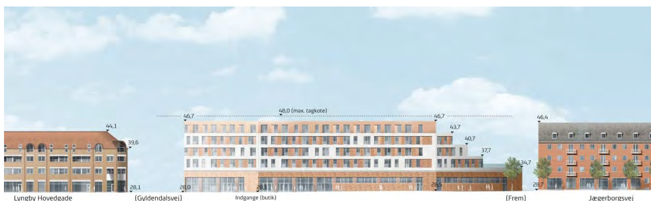
Principiel facadeillustration langs Lyngby Hovedgade, der viser en eventuel ny bebyggelses højde i forhold til nabobebyggelserne.
