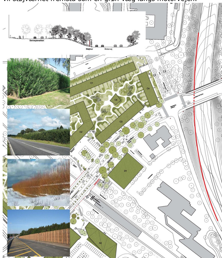
Figur 16: Illustration af placering af støjskærm samt udformning af denne med skærmende beplantning
