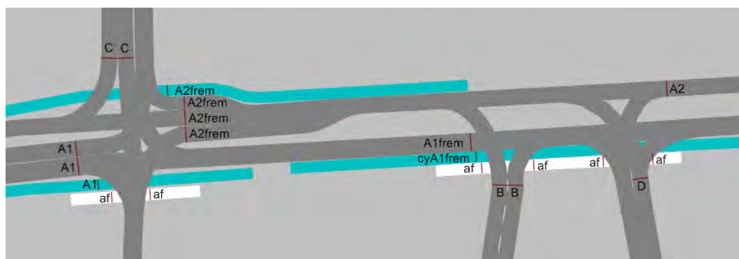
Figur 2. Placering af signaler samt signalfaser.
