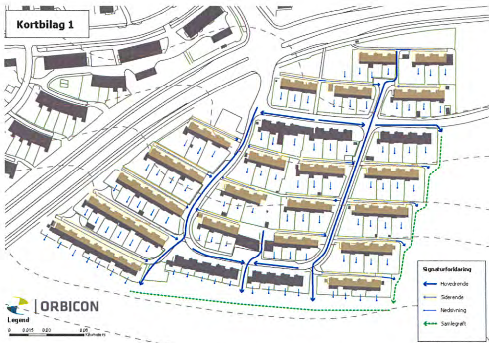
Figur 2: Strømningsveje for afledning af regnvand på terræn.
