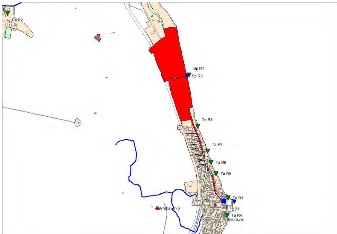
Figur 2-9 Oversigt over det planlagte tiltag ved Taarbæk. Frakobling af vejvand i Taarbæk fremgår af de røde markeringer. Signaturforklaring ses på Figur 2-3.
