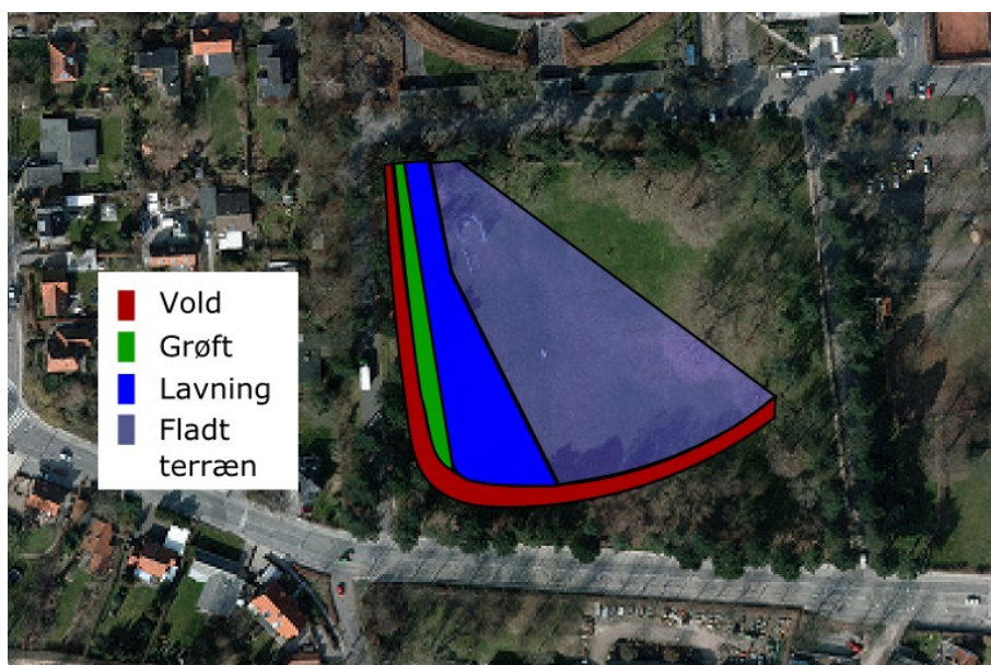
Regnvandsbassin i Badeparken
