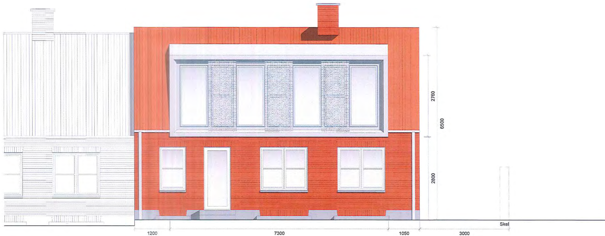
Principskitse - yderside af kastelkvist flugter med tagrende
