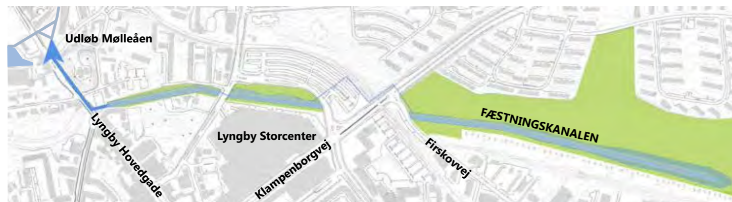
Regnvandet fra byen ledes via den reetablerede Fæstningskanal fra Ermelundskilen i øst til Lyngby Hovedgade i vest, før det i sidste ende udledes i Mølleåen.
