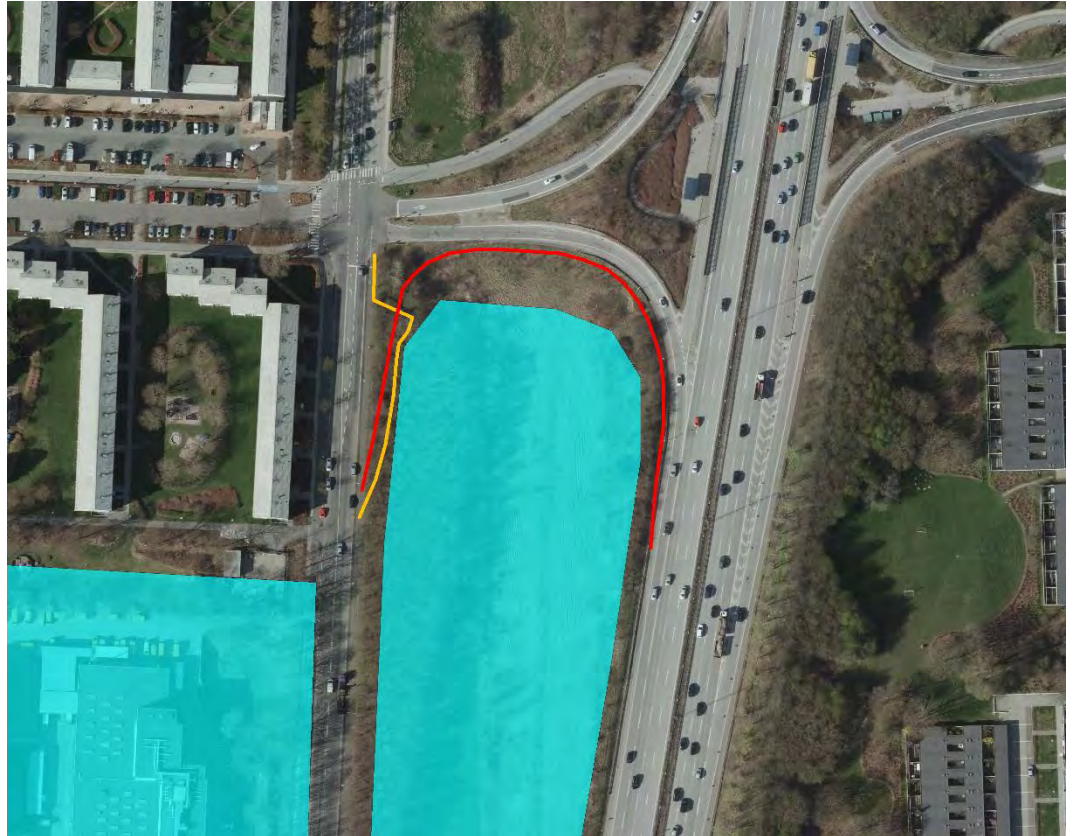
Figur 14: Principskitse af en shunt ved tilkørslen til Helsingørmotorvejen ved Lundtofte. Den røde linje viser shunten. Den gule linje viser cykeltrafikken.
