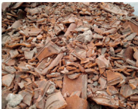
Tagsten fra nedrivning.
